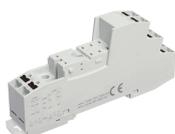
Relais-Stecksockel PRS, für Miniatur-Leistungserlais mit 2-Wechsler, Push-in Anschluss, Steckmöglichkeit für Eingangs-/Entstörmodule und Querverbinder, Montageart: TS 35, Bemessungsquerschnitt: 1,5mm<sup>2</sup>, Bemessungsspannung 300V
