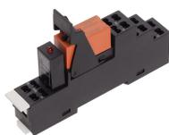
Vormontiertes Relaismodul PRS..., Zugfederanschluss, bestehend aus: Relaissockel, Leistungskontaktrelais, steckbarem Anzeige-/ Entstörmodul und Haltebügel, 1 Wechsler, Eingangsspannung: 24 VDC
