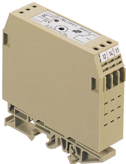
Einschaltverzögertes Zeitrelais, Zeitbereich: 3s - 30 s, Schraubanschluss, Montageart: TS 35, 1 Wechsler, Versorgungsspannung: 24 VAC/DC
