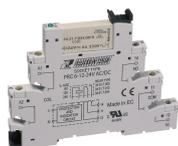
Plug-Relais-Compact (PRC) Komplett, bestehend aus Sockel PRC... mit Schraubanschluss und steckbarem Miniaturrelais PRC... mit Leistungskontakt, Montageart: TS 35, 1 Wechsler, Eingangsspannung: 6 VDC
