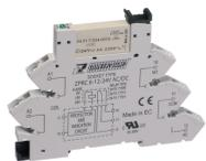
Plug-Relais-Compact (PRC) Komplett, bestehend aus Sockel PRC... mit Zugfederanschluss und steckbarem Miniaturrelais PRC... mit Leistungskontakt, Montageart: TS 35, 1 Wechsler, Eingangsspannung: 12 VAC/DC
