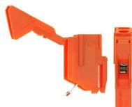
Transformatorenklemme, Schraubanschluss, Montageart: Sonderprofile, Bemessungsquerschnitt: 4 mm<sup>2</sup>, Breite: 7,5 mm, Farbe: Orange
