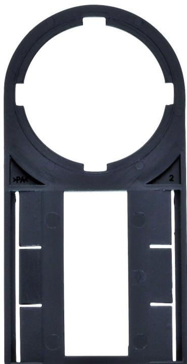
Schildhalter, einsetzbar für alle Taster und Schalter mit 22 mm Durchmesser, schwarz, unbeschriftet, Montageart: schrauben, nieten, Durchmesser 22 mm, Schriftfeldgröße: 27 x 27 mm, Farbe: Schwarz
